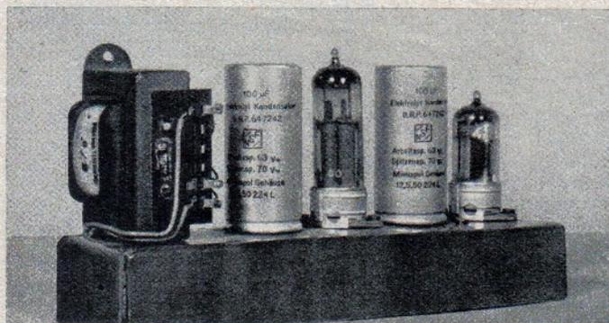
Abb. 9. Baueinheit Verstärkerteil des Verstärkers nach Abb. 7
